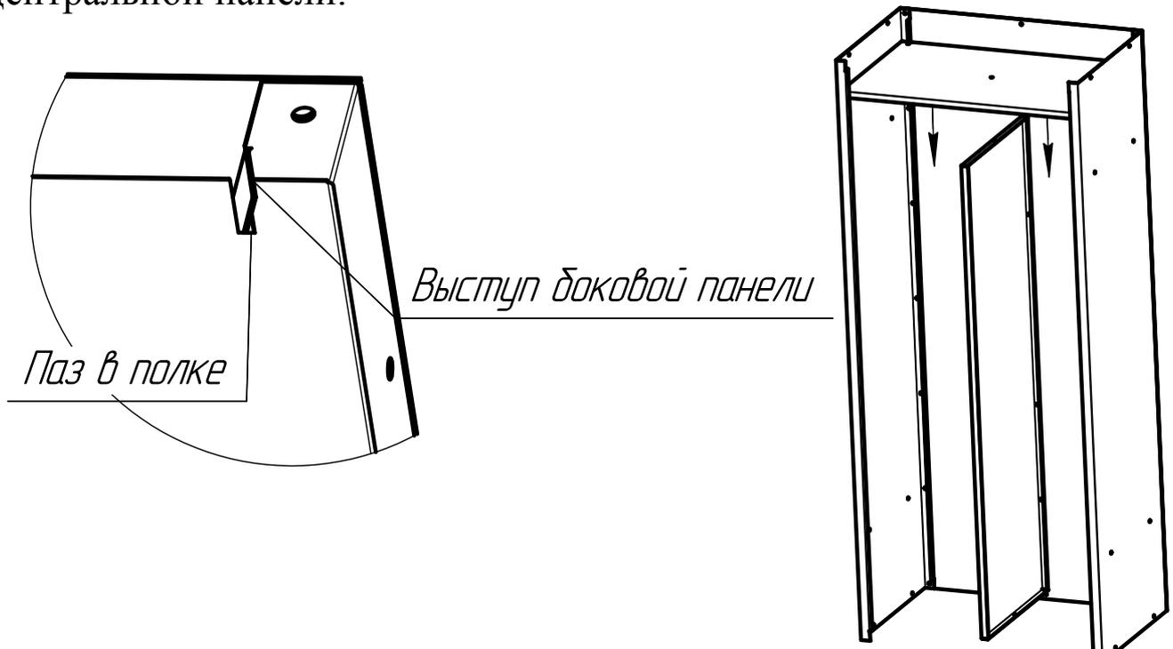
Установите и затяните болты крепления полки к боковым стенкам, а так же верхний болт в отгибе средней панели, не установленный ранее. Крепление полки к средней панели в этом шаге не устанавливается. Затяните болты крепления средней панели к задней стенке.
