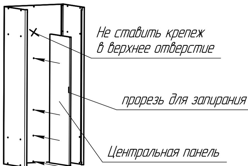
При монтаже не устанавливайте крепеж в верхнее отверстие центральной панели. Свинчивание остальных точек крепления выполнить предварительно, без затяжки крепежа.
